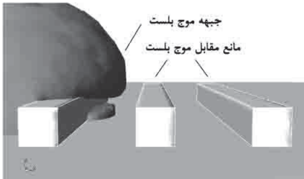
شکل ۱- شبیه‌سازی اثر حضور موانع بر مشخصات موج بلست در محیط باز [۷].
