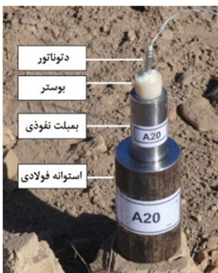
شکل ۳- شمایی از چیدمان تست نفوذ.
