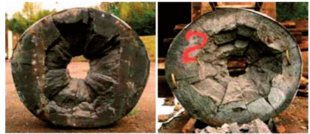
شکل ۳- نفوذ کامل در هدف بتنی الف- نمای روی، ب- نمای پشتی [۷].
