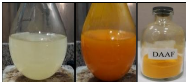
شکل ۱۰- مراحل سنتز دی آمینوآزوکسی DAF قبل از افزایش اکسون (سمت چپ)، بعد از افزایش اکسون (وسط) و محصول DAAF (سمت راست).
