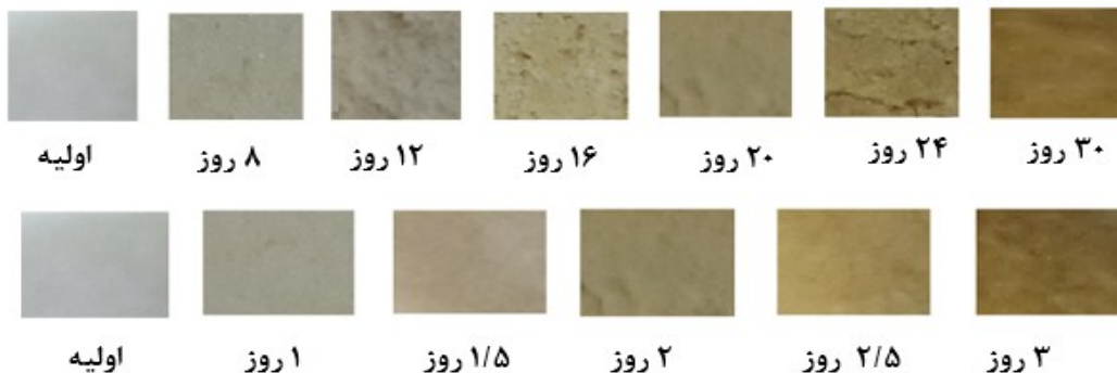
شکل ۸- تغییرات رنگ C4 در دمای ۱۲۰ °C (بالا) و ۱۴۰ °C در زمان‌های مختلف.
