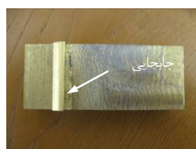
شکل ۶- نمونه عملیات حرارتی شده بعد از آزمایش برش
