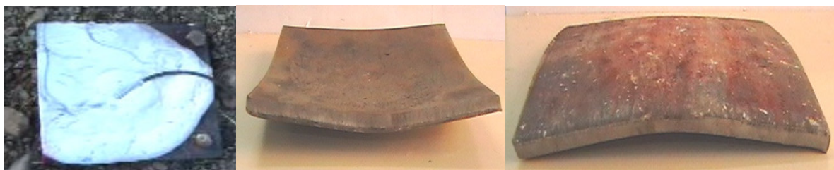
شکل ۱- تاثیر حدود ۵۰ گرم فوم انفجاری پخش شده بر روی صفحه فولادی به ابعاد ۲۰ در ۲۰ و ضخامت ۱ سانتی‌متر [۱].
