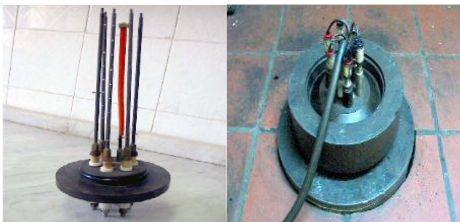
شکل ۲- بمب کرافورد برای آزمون سرعت سوزش.
