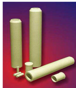
شکل ۹- نمونه ای از پیشرانده فومی تولید شده در موسسه فرانهورفر
