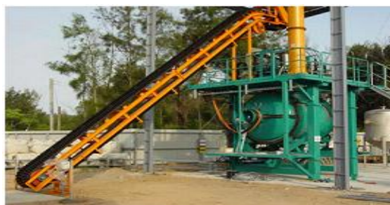
شکل ۵- کوره ثابت Dynasafe AB [۵].
