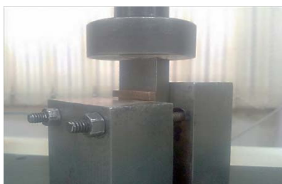
شکل ۴- نمایش آزمون استحکام سنجی برش کششی اتصال جوشکاری انفجاری.
