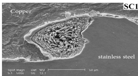
شکل ۱۰- تصویر میکروسکوپ الکترونی روبشی از منطقه ذوب موضعی منجمد شده، در نمونه SC1.
