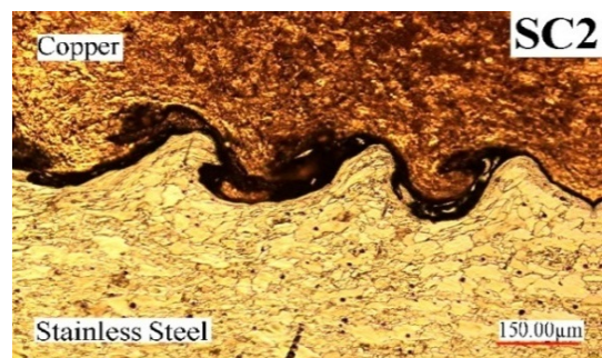
شکل ۷- تصاویر میکروسکوپ نوری فصل مشترک اتصال در بزرگنمایی (×۱۰۰).
