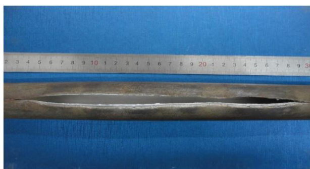
شکل ۲۳- تصویر "نمونه ۴" با یک شکاف طولی بزرگ [۳۴].
