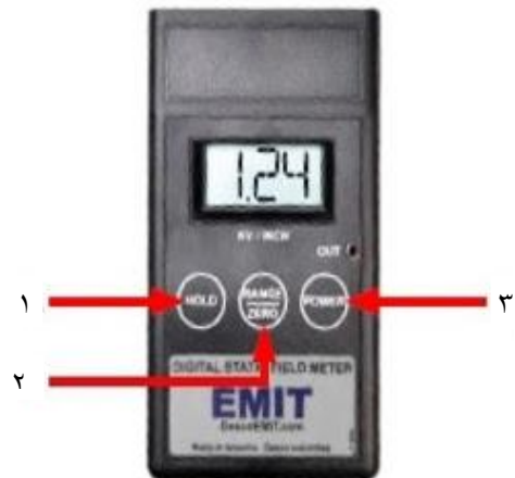
شکل ۱۱- نمایی از میدان سنج مدل EMIT 50597 [۱۹].
