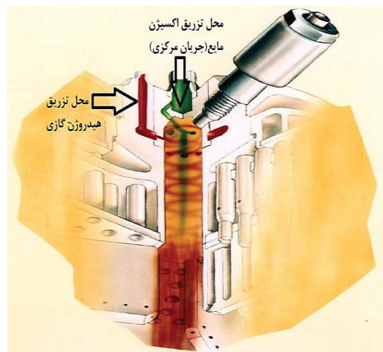
شکل ۳- نحوه تزریق اجزای پیش‌رانه به داخل محفظه احتراق آتشزنه در موتور اصلی شاتل فضایی [۱۹].
