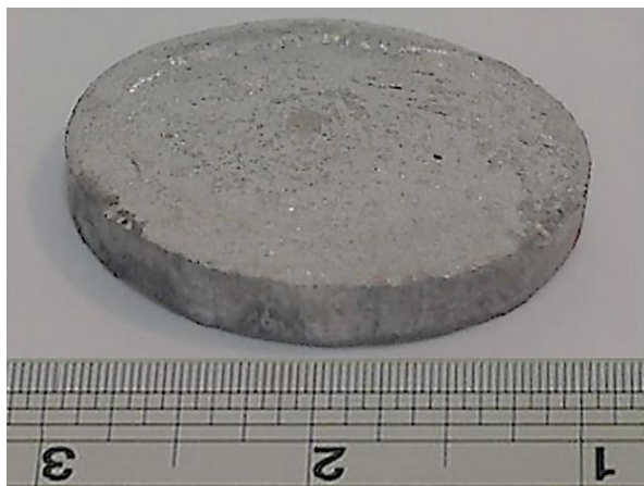
شکل ۱۷ - قطعه تولیدشده به روش تراکم انفجاری زیرآب.
